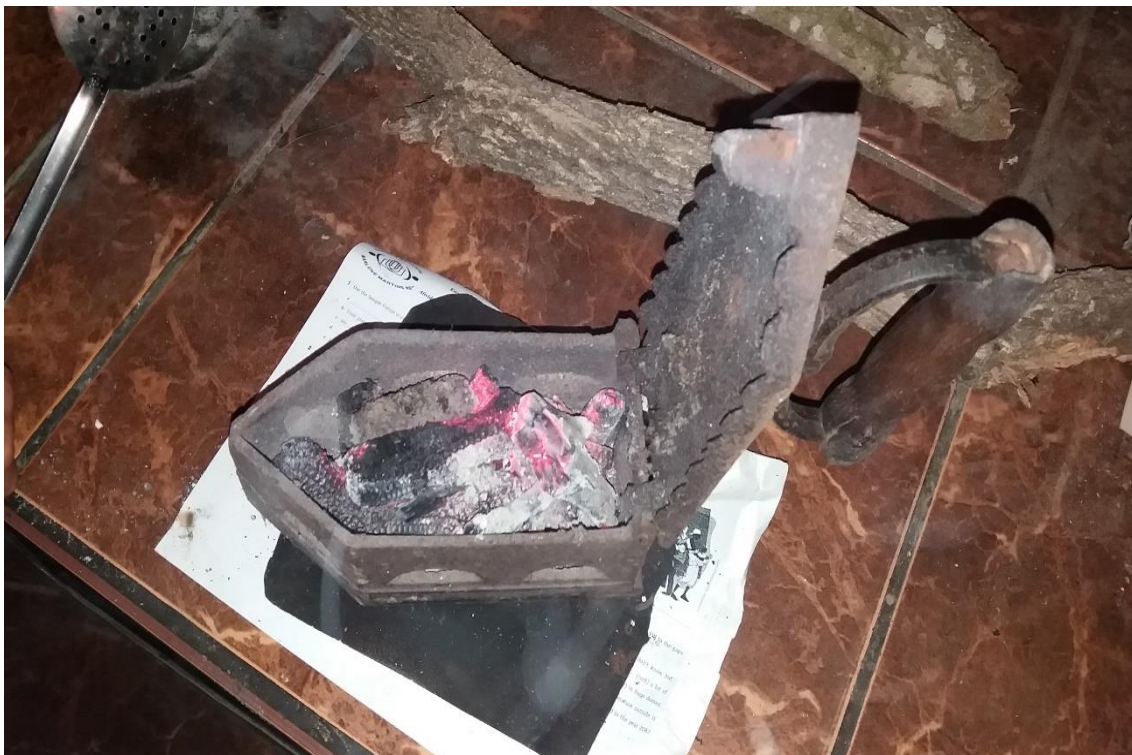
Ferro de passar, com as brasas que o aquecem. Foto: Cristiano Eustáquio Valeriano, Abril 2019.
